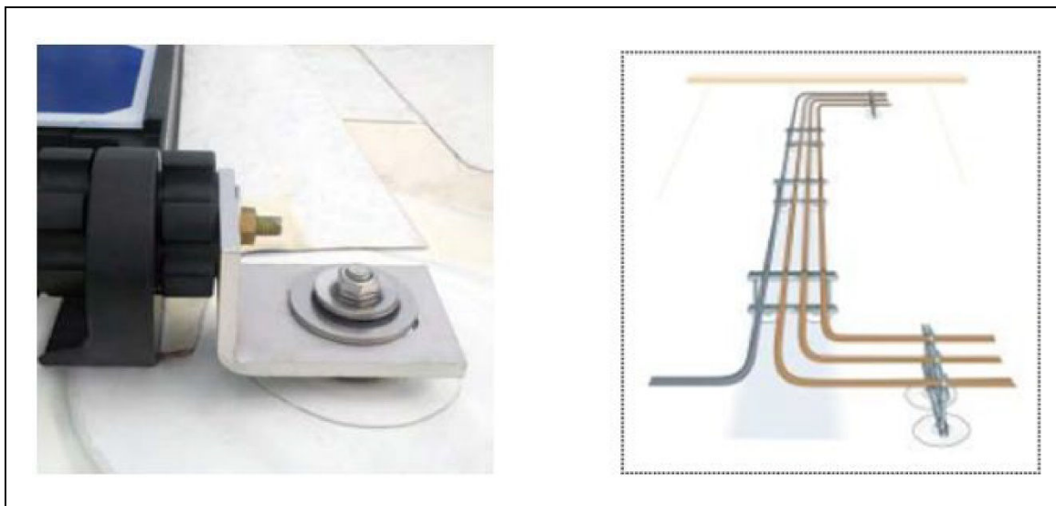
Figures 2.1.1.9-1a et b. Ancrages mécaniques utilisés pour fixer les équipements au bac ou à la structure du toit
