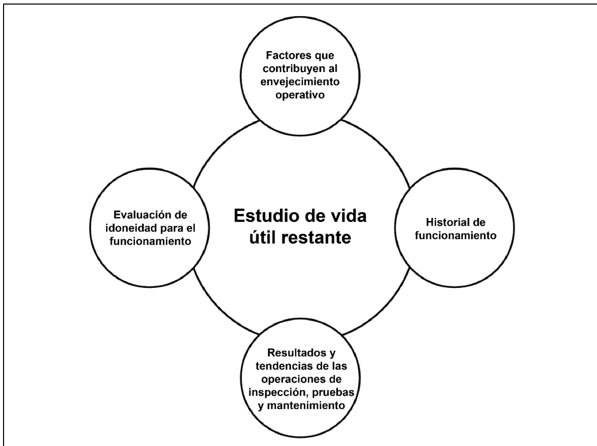
Fig. 3.3.1.3. Estado de los equipos que afectan a la realización de un estudio de vida útil restante
