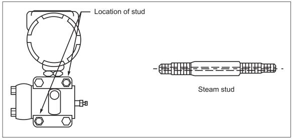
Fig. C.1.5-3. Steam stud arrangement
