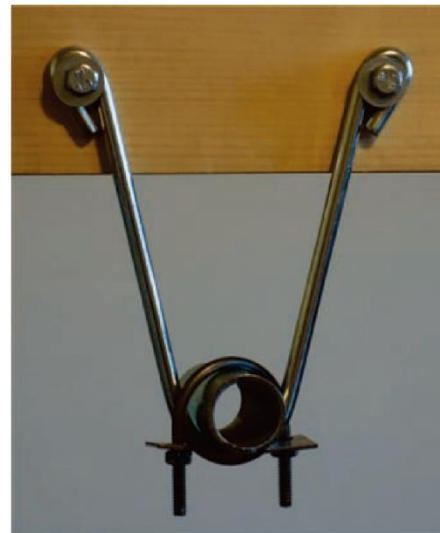
Soporte en U con correa de sujeción en U para evitar el movimiento ascendente
