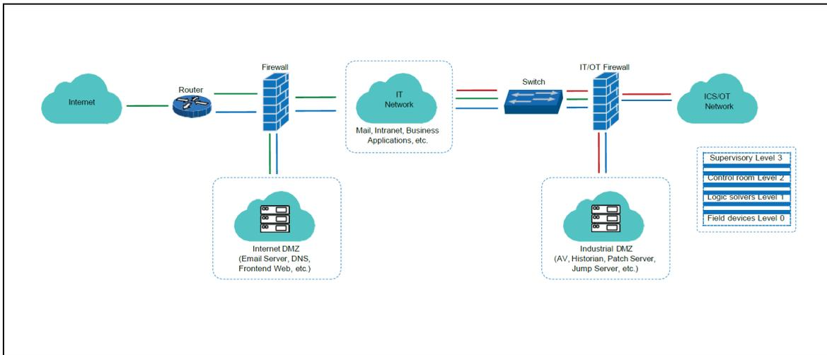
Figura 1. Ejemplo de ruta de comunicación que muestra la red perimetral corporativa y de Internet y la red perimetral industrial y de los SCI
